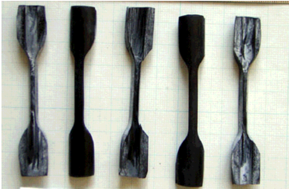
photo 3 :Éprouvettes Durite Renault après immersion E85
