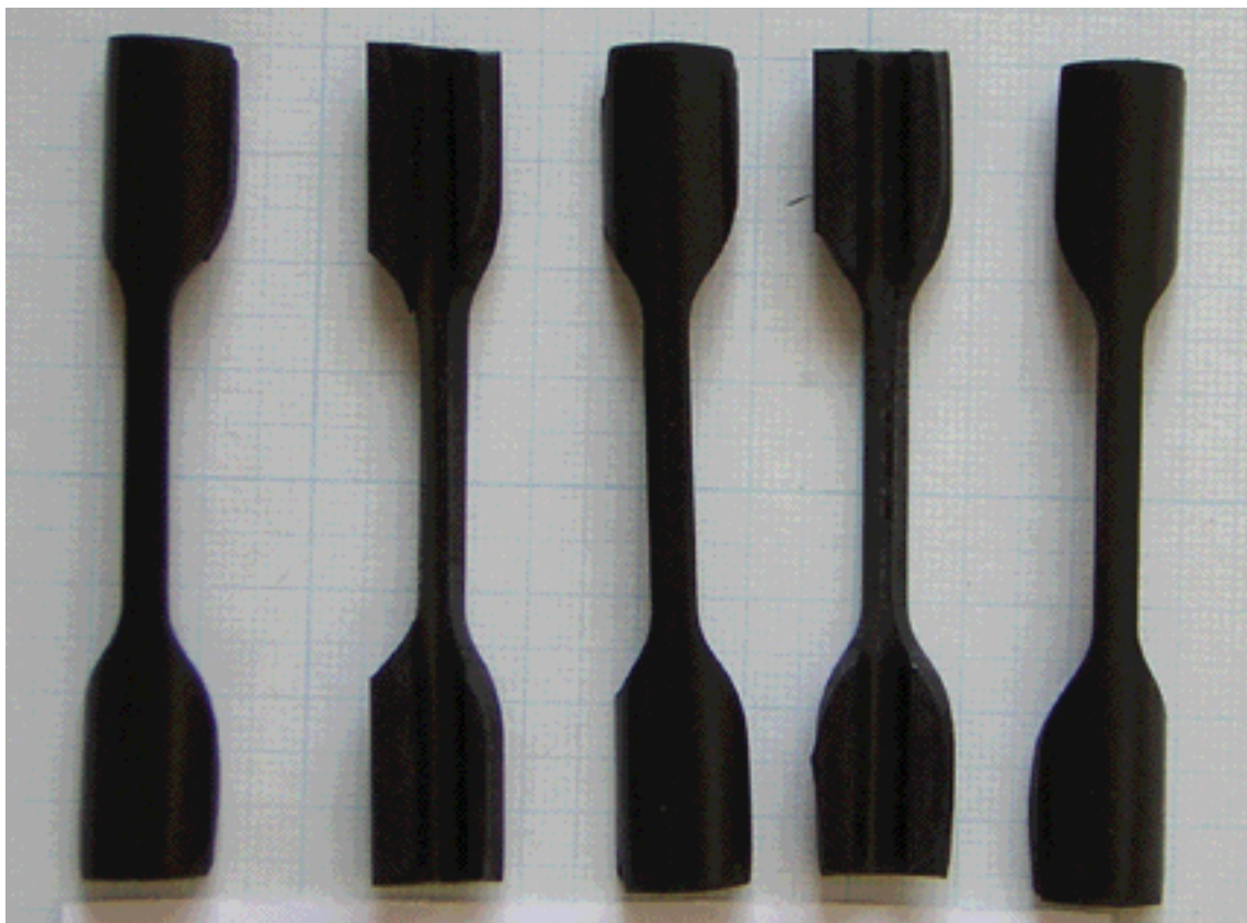
photo 4 : Éprouvettes Durite Renault après immersion dans SP98
