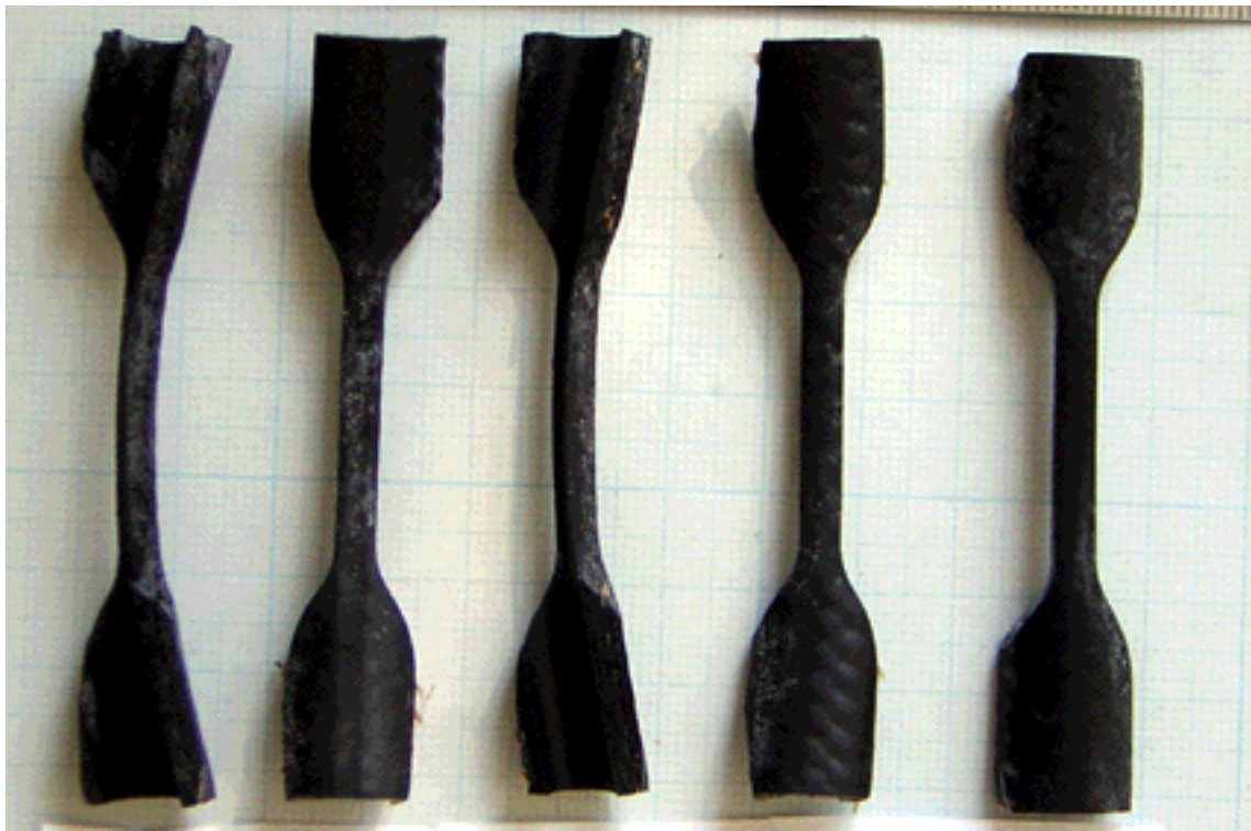
photo 6 : Éprouvettes Wurth après immersion dans le E85
